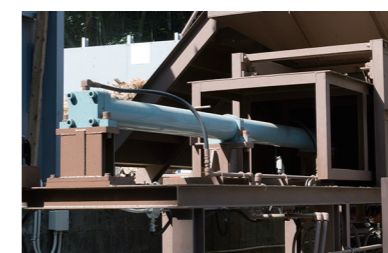
■ 定量自動投入装置 投入時
